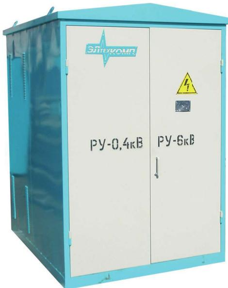
Комплектные трансформаторные подстанции наружной установки тупикового типа на напряжение 6(10) кВ предназначены для приема, преобразования и распределения электрической энергии трехфазного переменного тока частотой 50 Гц при номинальном напряжении 0,4 кВ.
