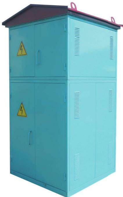
Подстанции трансформаторные комплектные тупиковые мощностью 25, 40, 63, 100 кВА, напряжением 6 или 10 кВ, напряжением НН 0,4 кВ предназначены для приема, преобразования и распределения электрической энергии трехфазного переменного тока частотой 50 Гц в системах с глухозаземленной нейтралью трансформатора на стороне низшего напряжения.
